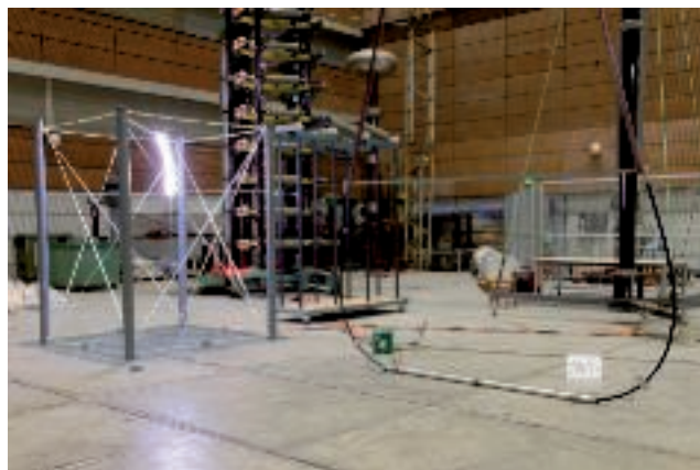
Zkušební sestava během zkoušení rázovým napětím s ekvivalentní oddělovací vzdáleností ( s_e ) 75 cm.
