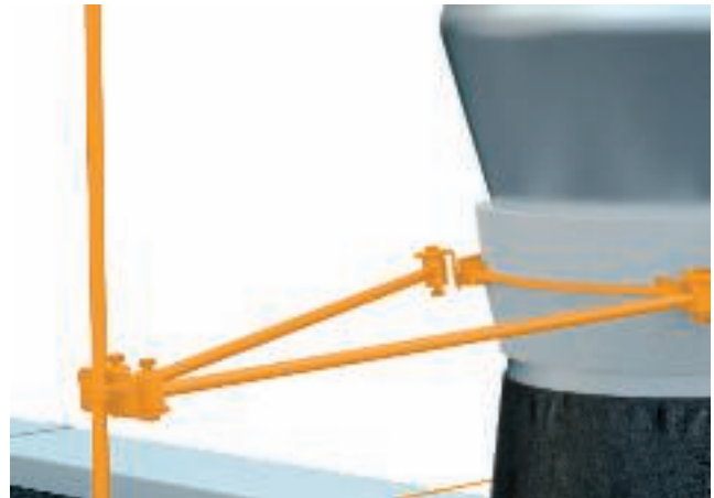
Příklad: Jímací systém s kombinovanou sadou Iso pro připevnění k trubce ve tvaru V
