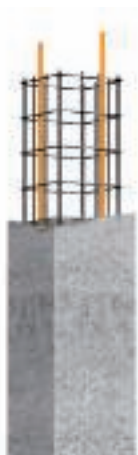
Příklad použití armovaných betonových sloupů / svodového zařízení
