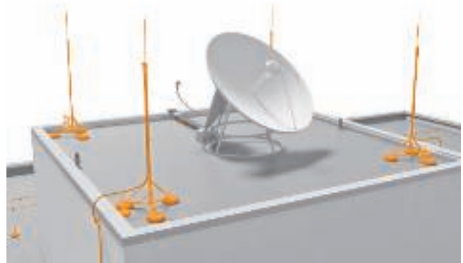
Oddělená ochrana před bleskem s jímacími tyčemi
